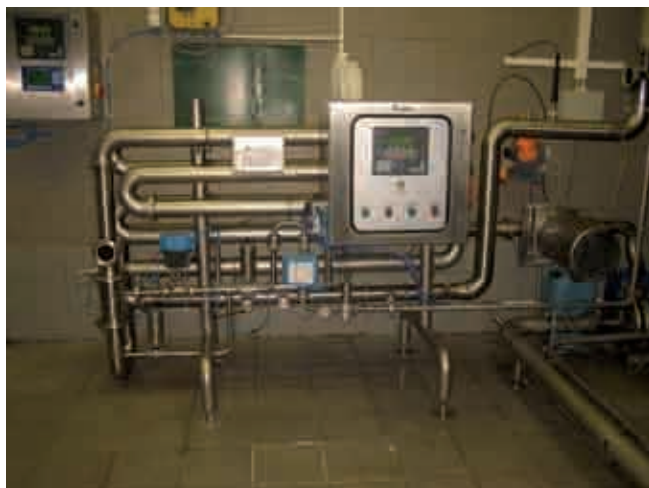
Zařízení ředící „pivní koncentrát“ na požadovanou stupňovitost – HGB Foto: Archiv autora
