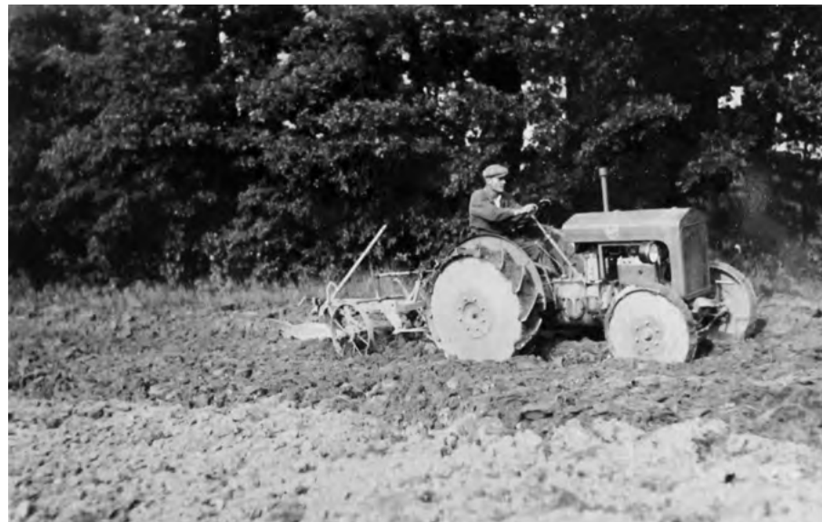
Obr. 4 Traktor Praga (AT 20-25), hluboká orba s dvouradlicovým pluhem, (Státní výzkumná zemědělská stanice v Libějovicích, okr. Netolice, 1931). Fotoarchiv NZM, skup. 2.1.9., odd. 5921-B35.
