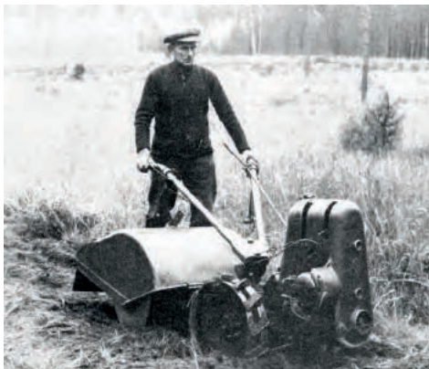
Fréza Siemens, č. neg. 99865-a29772 Kypřič půdy Siemens o výkonu 8k, motor jednoválcový, dvoutaktní, vzduchem chlazený. Výrobce Siemens-Schuckert-Werke, Německo
