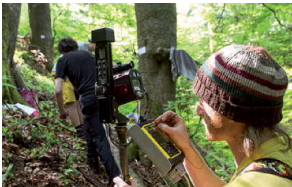
7 Na výzkumných plochách probíhá měření několika strukturních charakteristik porostu. Jednou z nich jsou pozice stromů, které jsou zaznamenávány pomocí technologie pro terénní sběr dat Field-Map. Zdroj: foto Ondrej Kameniar (2017).
