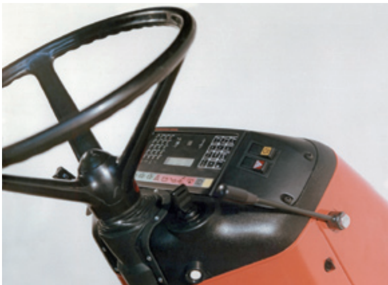
4 Přístrojová deska se systémem Zetortronic pro Unifikovanou řadu I. Design Zdeněk Zdařil. Spolupráce s firmou Hessel. 1987. Maketa 1 : 1. Zdroj: archiv Zdeňka Zdařila.
