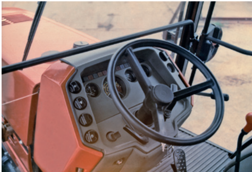
8 Přístrojová deska Unifikované řady III. Design Zdeněk Zdařil. Sériová výroba od 1991. Zdroj: archiv Zdeňka Zdařila.
